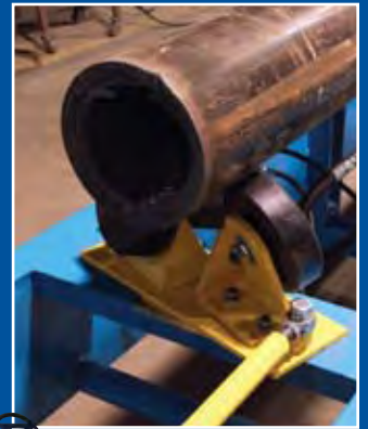
Máquina para la limpieza de tuberías
